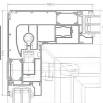
UG 90°-os sarokmegoldás - keresztmetszet
